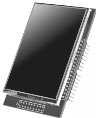
图 1-14 Arduino 2.8in TFT LCD
